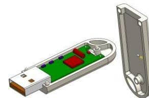
*Vous devez placer une première contrainte entre les deux demi-coques : un trou de la 2<sup>nde</sup> coque dans un ergot de la 1<sup>ère</sup>. Sélectionnez la fonction **Contrainte**. Cliquez sur la partie cylindrique de l'ergot puis sur le trou.*
