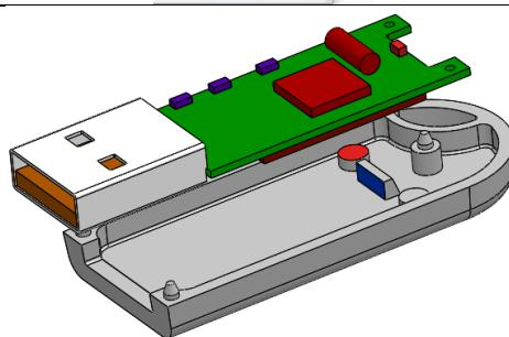
**Vous allez positionner la coque sous la carte électronique. Dans le langage SolidWorks cela s'appelle placer des Contraintes.**
