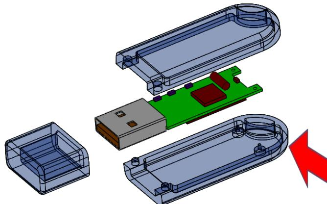
La première partie consiste à modéliser la demi-coque inférieure du boîtier de la clé USB, fléchée en rouge sur le dessin ci-dessus. Ensuite, vous réaliserez l'autre demi-coque ainsi que le bouchon afin de réaliser l'assemblage de la clé USB.
