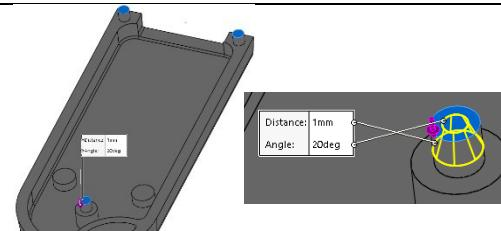
Vous allez réaliser maintenant une butée qui empêchera le PCB de reculer lors de l'insertion de la clé.
