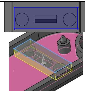
Vous remplacerez les 2 ergots avants par deux trous d'une profondeur de **3,3mm** et dont le diamètre est plus grand de 0,2mm par rapport au diamètre de l'ergot.
