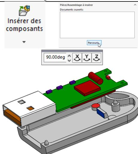
Sélectionnez le plan de face de l'assemblage puis le plan de droite de la demie-coque inférieure et choisissez la contrainte « **Coïncidente** ».
