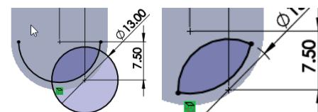
La fonction **Enlèvement de matière par extrusion** fera le "trou" de passage pour la dragonne.
