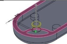
Selectionnez la surface supérieure de chaque ergot en vue de réaliser un chanfrein de longueur 1mm avec un angle de 20 degrés sur chacun des ergots. Ces chanfreins auront pour fonction de faciliter l'emboîtement des deux demi-coques.
