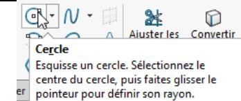
Tracez un cercle dont le centre se trouve sur la ligne de construction et dont le tracé coïncide avec l'extrémité du segment de gauche. Placez le curseur au-dessus de l'extrémité du segment vertical (sans cliquer) puis déplacez-le au-dessus de l'axe ; cliquez ; rejoignez le point de gauche ; cliquez ; validez.
