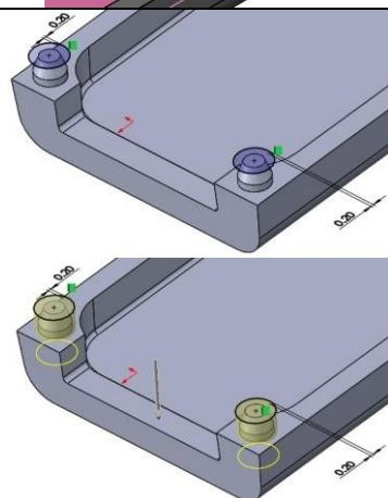
Enfin, il faut réaliser un trou dont le diamètre est plus grand de 0,2mm par rapport à l'ergot arrière → esquisse puis enlèvement de matière borgne sur une profondeur de **3.3mm**.
