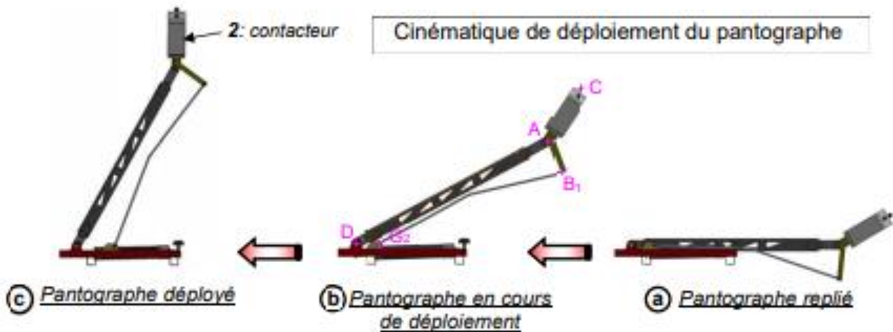
Schéma cinématique du pantographe
