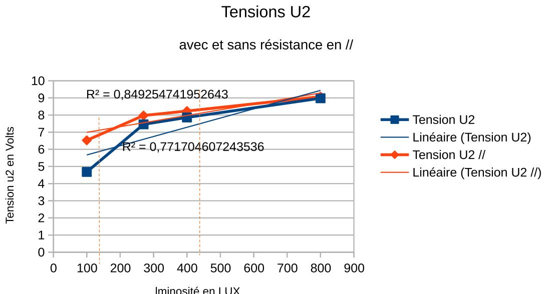
L'ajout d'une résistance en // de la LDR permet de rédu
