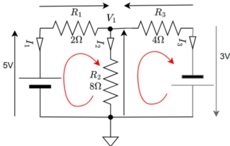
Le circuit ci-dessus est constitué de deux nœuds (A et B). Au nœud A la quantité de charges doit rester constante.
