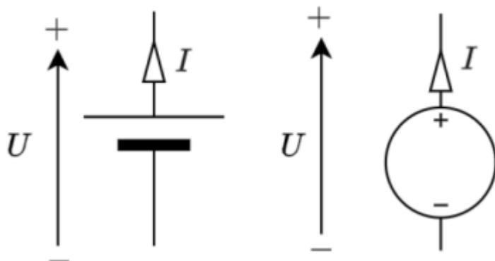
Une pile ou un accumulateur peut se représenter de cette manière. Dans un récepteur, le courant I lui se déplacera du potentiel le plus haut vers le potentiel le plus bas. Par contre dans un générateur comme une pile le courant I lui se déplacera du potentiel le plus bas vers le potentiel le plus haut car c'est justement le rôle du générateur d'accélérer les électrons dans le conducteur.
