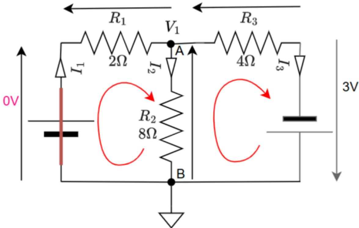
On court-circuite le premier générateur. Déterminons  $I_1''$ ,  $I_2''$  et  $I_3''$ . La résistance de 2 ohms se retrouve en dérivation de la résistance de 8 ohms.
