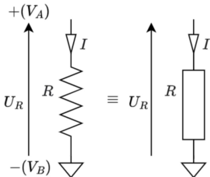
Ci-dessus est représenté une résistance à la norme européenne IEEE. Pour indiquer une tension on place généralement un flèche partant du potentiel le plus bas (-) au potentiel le plus haut (+).
