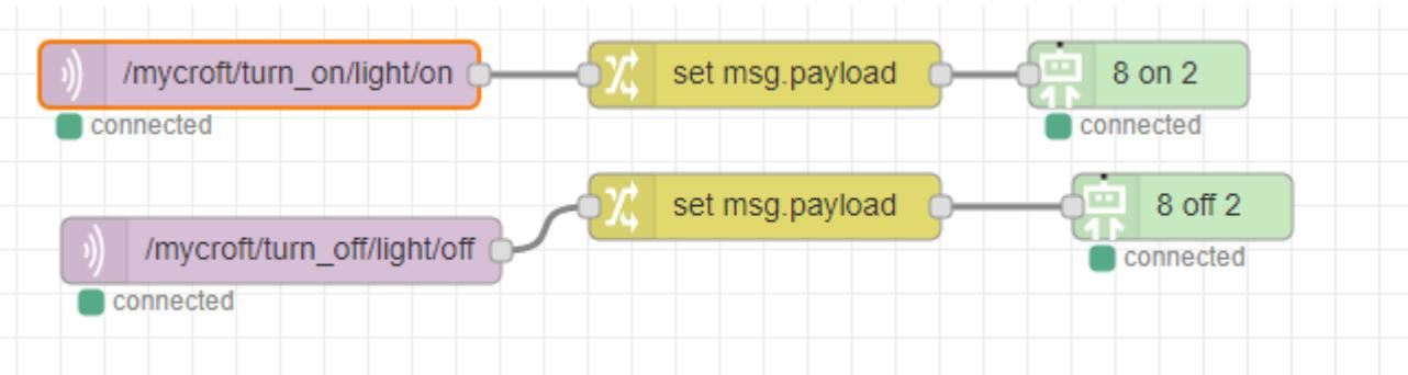
Sur Node-Red il suffit d'ajouter les briques MQTT qui réceptionnent les messages provenant de l'assistant PiCroft et de piloter le GrovePi en conséquence ;)
